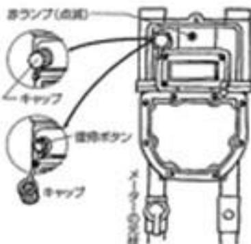
長時間ガスを仕様し続けると、ガスメーターの安全装置が自動的に作動し、ガスの供給をストップします。その場合は図のように赤ランプが点滅しているので、次の手順で操作して下さい。
